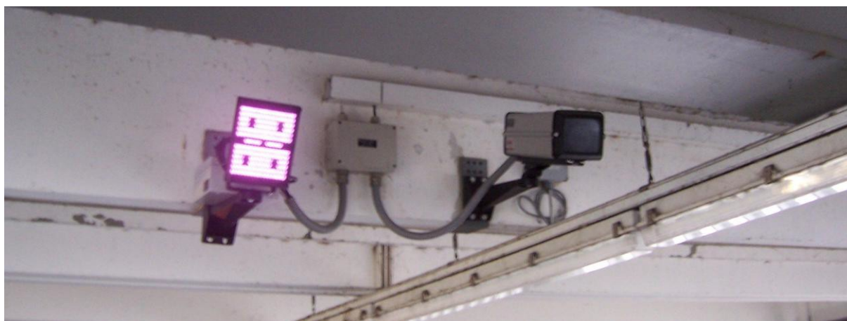
Système de surveillance utilisé en Suisse et en Allemagne. Il comprend un système de reconnaissance faciale, de reconnaissance de véhicule (marque, modèle, couleur) et un lecteur de plaque d'immatriculation. Crédit : Maraparrac / English Wikipedia.
